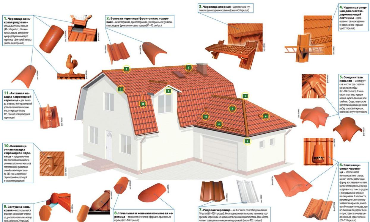
**Дополнительное крепление.** Элементы цементно-песчаной черепицы удерживаются на рейках обрешетки благодаря зацепам, спрофилированным на тыльной стороне черепицы. Очередной ряд цементно-песчаной черепицы прижимает предыдущий и защищает места крепления. Однако некоторые элементы черепицы следует дополнительно закреплять независимо от угла наклона ската. Это элементы:
